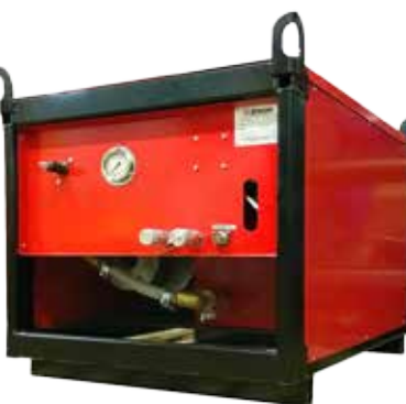
Насосные станции для гидроскоб
