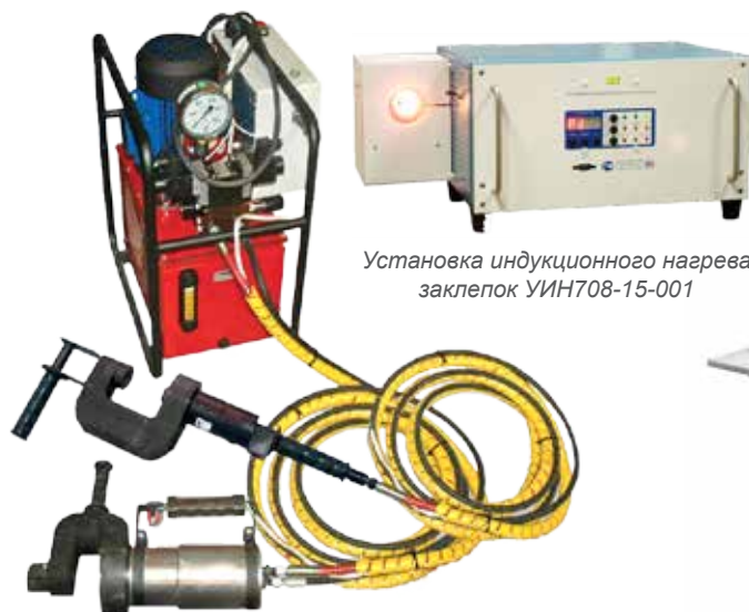
Установки для снятия (выпрессовщики) и постановки заклепок фрикционных планок
