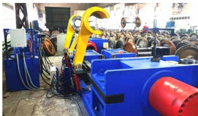
Электрическое оборудование обеспечивает питание и управление пресса, а также возможность управления им. Электрическое оборудование состоит из силового и управляющего распределительных щитов, главной панели управления, вспомогательного пульта управления и разводки кабелей с переходными клеммами.
