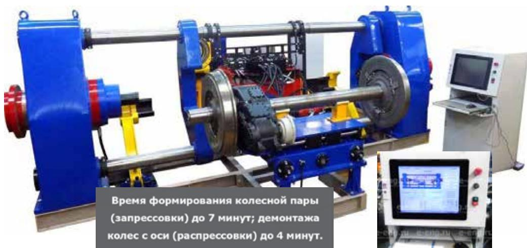
Конструктивные составляющие пресса ПГКП-150: опорная рама, стойки силовых гидроцилиндров, тяги, силовые гидроцилиндры, упоры откидные, упоры распрессовочные, каретка подачи со столом и опорные призмы.
