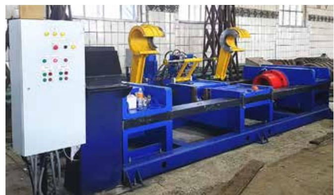
струкции из деталей типа «поковки» и сварных листов. Траверса крепится к раме усиленными болтами.
