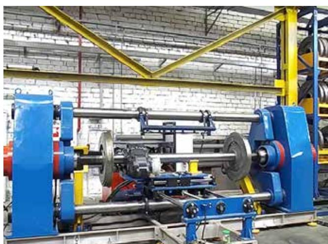
Для распрессовки колёсной пары при выбраковке используются упоры распрессовочные. Они выполнены в виде сварной коробчатой конструкции и обеспечивают необходимую жёсткость при распрессовке.
