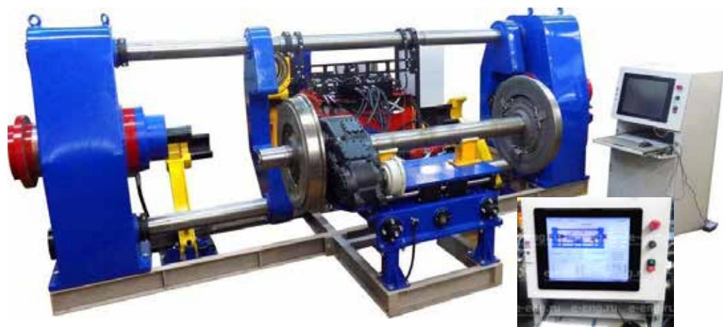
Конструктивные составляющие пресса ПГК-150: опорная рама, стойки силовых гидроцилиндров, тяги, силовые гидроцилиндры, упоры откидные, упоры распрессовочные, каретка подачи со столом и опорными призмами.
