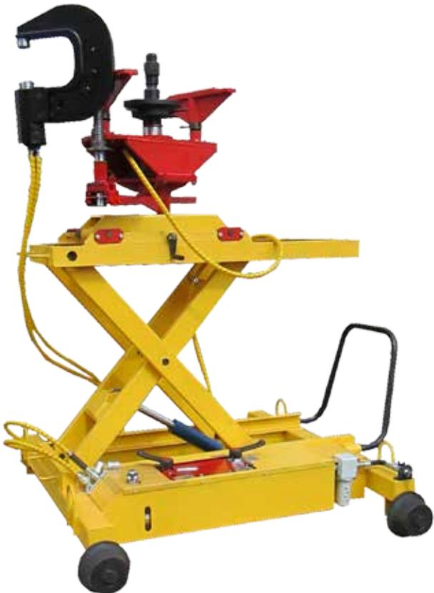
Гидроскоба(клепатор), устанавливаемая на гидроподъёмнике, обеспечивает необходимое качество клепанного соединения.
