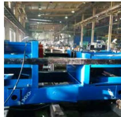
■ **Высокое качество и оптимальное конструктивное исполнение.** Силовая часть пресса выполнена из листовой стали толщиной 100 мм, что исключает деформации металлоконструкций, увеличивает срок эксплуатации пресса и гарантированно обеспечивает высокое качество расспрессовки.
