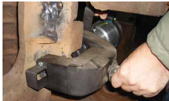
Управление работой инструмента осуществляется с помощью кнопок, размещенных на рукоятках выпрессовщика и клепатора. Все технологические операции выполняются одним рабочим.
