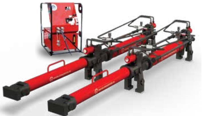
Отличительной конструктивной особенностью устройства является применение автоматически срабатывающих, гидравлически управляемых, взаимозаменяемых прямых и обратных зацепов новой конструкции, обеспечивающих надёжное выполнение толкающих и тянувших функций устройства, что обеспечивает надежное сцепление с рельсом при значительно меньшем усилии гидроцилиндров зажима, надёжное равномерное перемещение груза, без перекосов, даже в условиях «горки».
