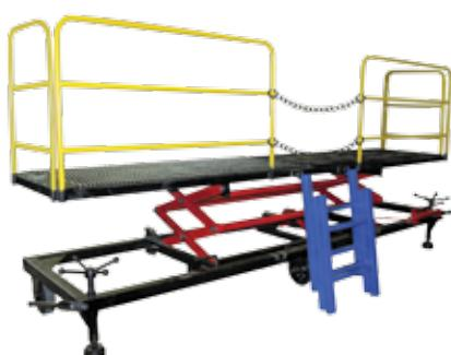
Подъемник оснащен страховочным упором, раздвижной лестницей, ограждением рабочей платформы, двумя аутригерами с фиксацией положения, двумя парами поворотных колес с тормозом и рукоятками для рулевого управления при перемещении подъемника.
