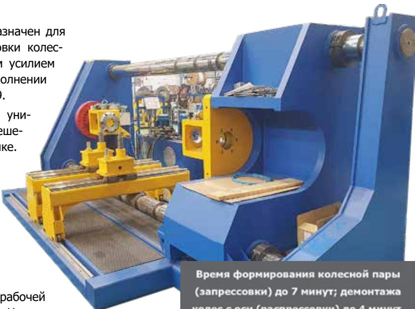
Время формирования колесной пары (запрессовки) до 7 минут; демонтажа колес с оси (распрессовки) до 4 минут.
