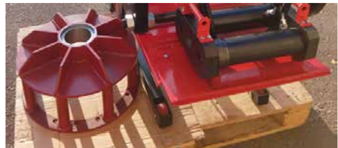
Монтажный рычаг, два вспомогательных держателя и гидравлический съемник
