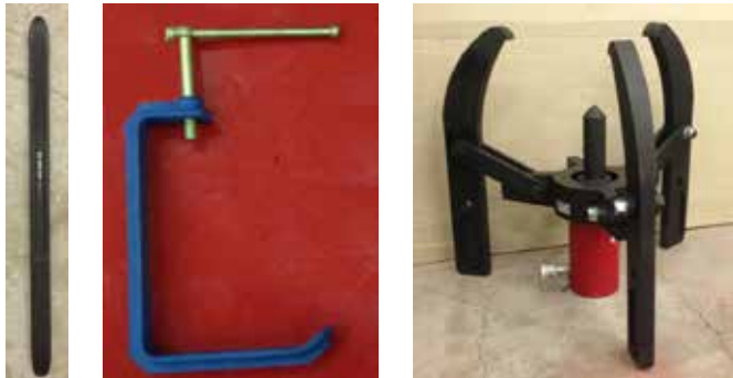
Монтажный рычаг, два вспомогательных держателя и гидравлический съемник
