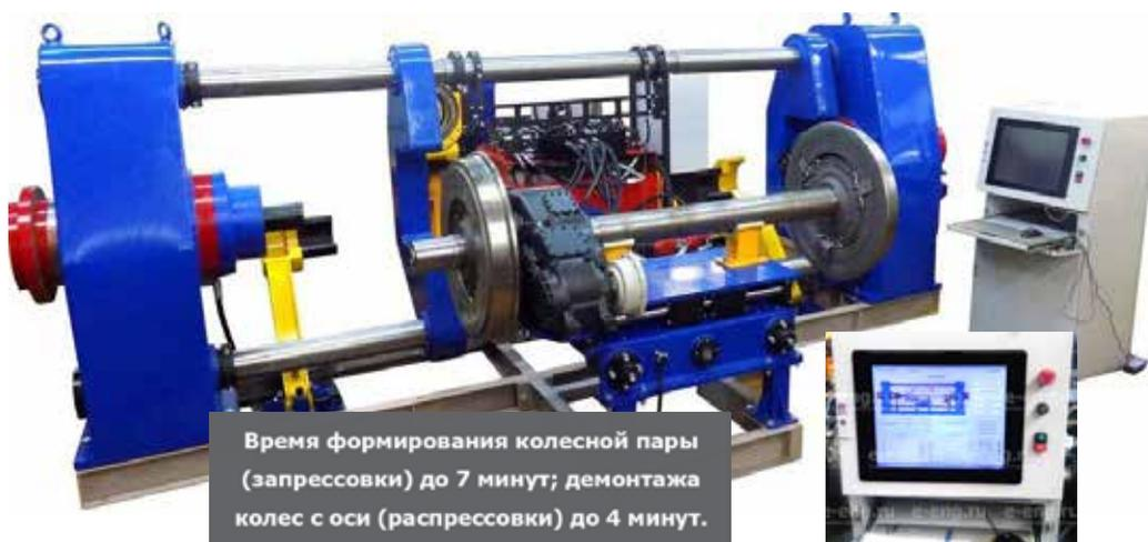
Время формирования колесной пары (запрессовки) до 7 минут; демонтажа колес с оси (распрессовки) до 4 минут.
