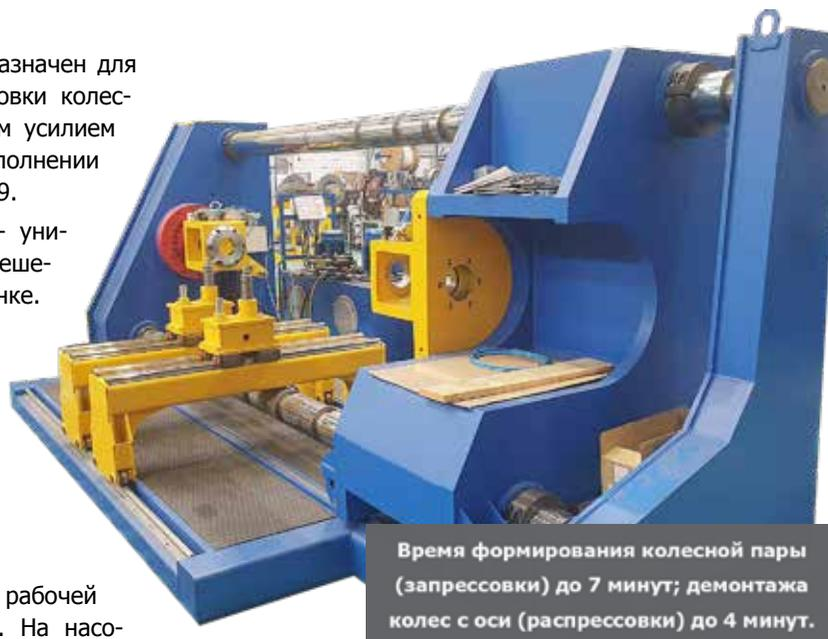
Время формирования колесной пары (запрессовки) до 7 минут; демонтажа колес с оси (распрессовки) до 4 минут.
