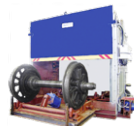
Оборудование для мойки колес и деталей вагонов
